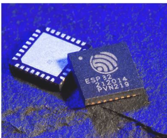
รูปที่ 5 หน้าตาของชิปไอซี ESP32 ในรูปตัวถัง QFN-42
